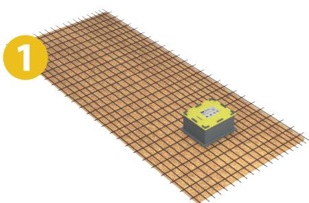
Découpe des armatures à l'emplacement de la réservation. Placement et ligature de la RÉZABOITE CV sur le fond de coffrage
